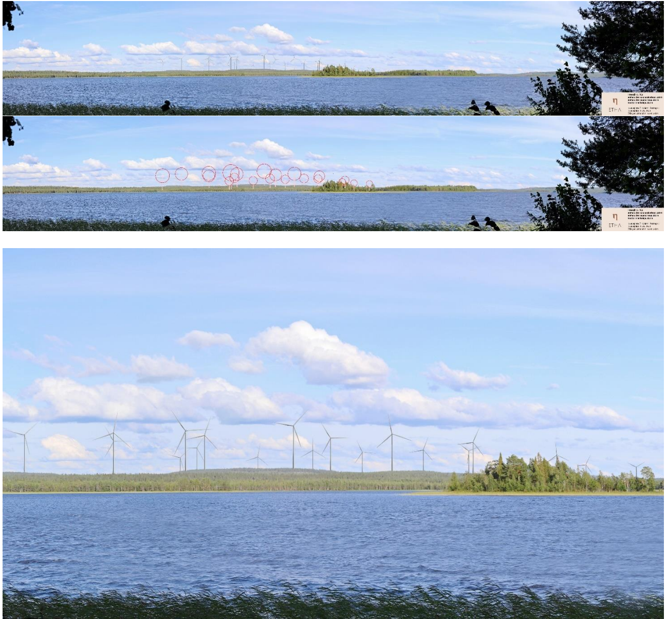
Kuva 11.14 Havainnekuva Tirroniemeltä. Etäisyys kuvauspisteestä voimaloihin on noin 4,6–11,6 kilometriä. Keskimmäisessä kuvassa on havainnollistettu voimaloiden tornit valkoisilla viivoilla ja laipojen pyörimisaluet punaisilla ympyröillä. Tarkennus vastaa noin 50 mm polttovälin objektilla otettua valokuvaa (todellisuudessa silmällä havaittava näkymä).
