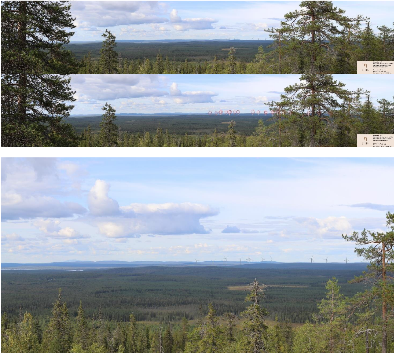
Kuva 11.16 Havainnekuva Aalistunturilta. Etäisyys kuvauspisteestä voimaloihin on noin 10,3–13,2 kilometriä. Keskimmaisessä kuvassa on havainnollistettu voimaloiden tornit valkoisilla viivoilla ja lapojen pyörimisaluet punaisilla ympyröillä. Tarkennus vastaa noin 50 mm polttovälin objektilla otettua valokuvaa (todellisuudessa silmällä havaittava näkymä).
